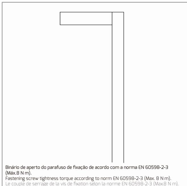
Binário de aperto do parafuso de fixação de acordo com a norma EN 60598-2-3 (Máx. 8 N m).
